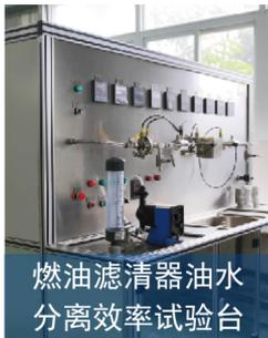
燃油滤清器油水分离效率试验台
