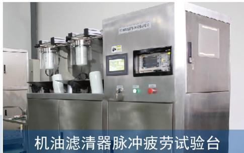
机油滤清器脉冲疲劳试验台
