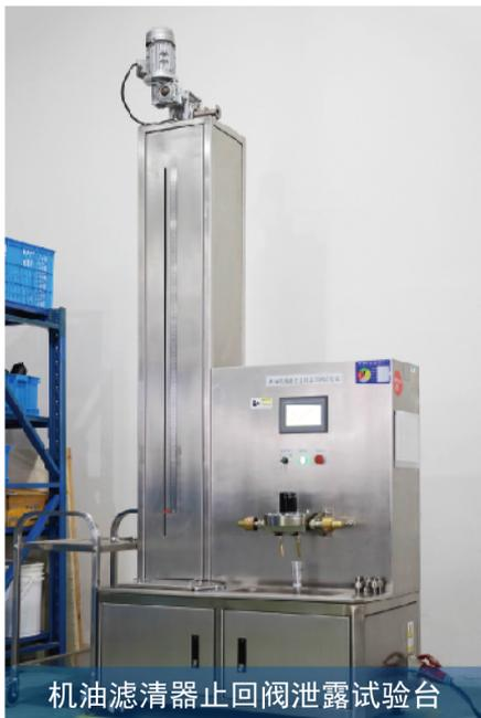
机油滤清器止回阀泄露试验台
